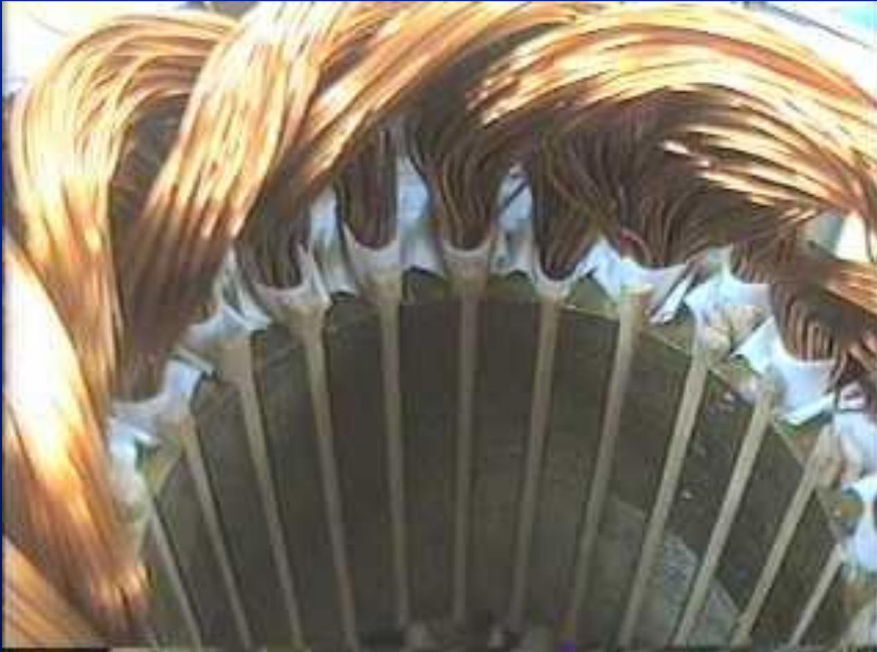
*Se refuerza el aislante y sujeta la bobina con una cuña de madera*
